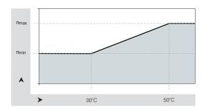
$$\begin{split} n_{\text{min}} \approx \ ^{1} / _{2} \, n_{max} \\ T_{\text{min}} \approx \ 30 \ ^{\circ}C; T_{max} = 50 \ ^{\circ}C \end{split}$$
